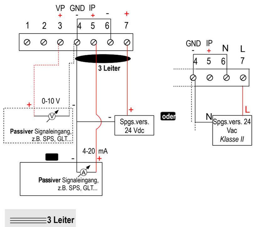
Für CP116-PO und CP116-PN Modelle mit 4-20 mA Ausgang – passiv :
