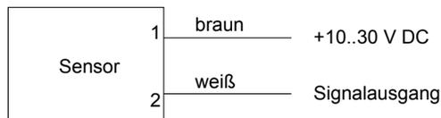
Vor der Elektroinstallation ist darauf zu achten, dass die Versorgungsspannung den Datenangaben entspricht.
